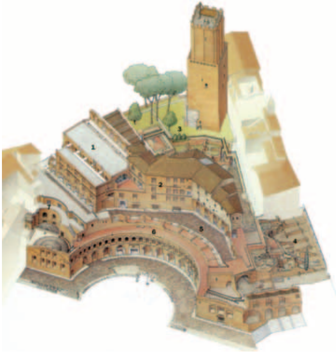
Fig. 4 - Assonometria dei corpi di fabbrica dei Mercati di Traiano con evidenziate le denominazioni moderne. 1 Grande Aula, 2 Corpo Centrale, 3 Giardino e Torre delle Milizie, 4 Insula della salita del Grillo, 5 Via Biberatica, 6 Grande Emiciclo e Aula di Testata, 7 Piccolo Emiciclo
